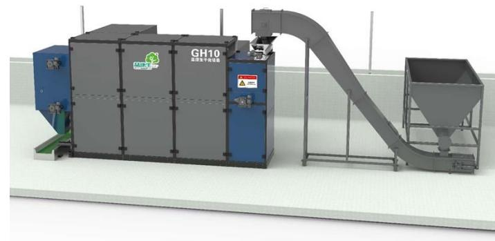
利用100-200°C热空气进行沼渣烘干，封闭式热循环，提高热量利用效率，连续出料，无明火安全稳定。
