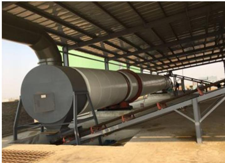
分离后的沼渣进入转筒烘干系统，利用沼气直燃或发电机烟气进行沼渣烘干。
