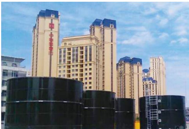
地铁工程泥浆储罐
